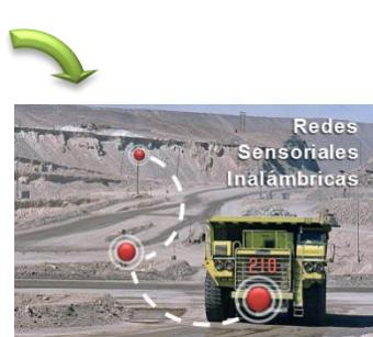
Sistema de módulos sensoriales “waspmove” (red sensorial tipo “mesh” 900Mhz), para personas, vehículos y camiones. Provee data para triangulación y estado de variables (movimiento, aceleración, temperatura y posición entre otros).
