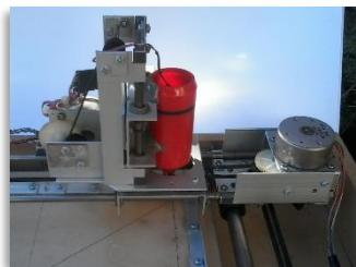
Máquina CNC para el perforado automatizado y manual, de tarjetas de circuitos impresos.
